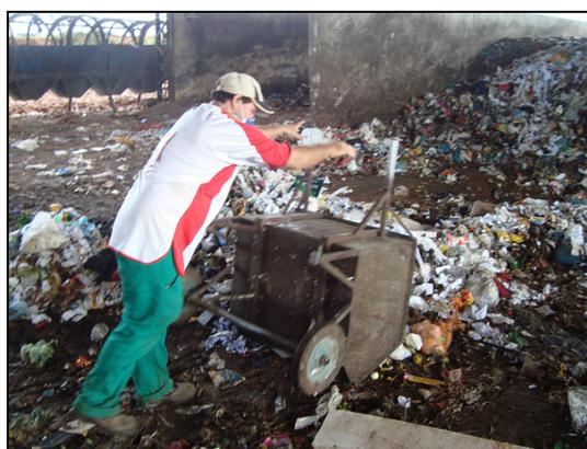
Figura 10.2-XLVII: Descarga do "rejeito da esteira de triagem" até a COMPOSTAGEM
