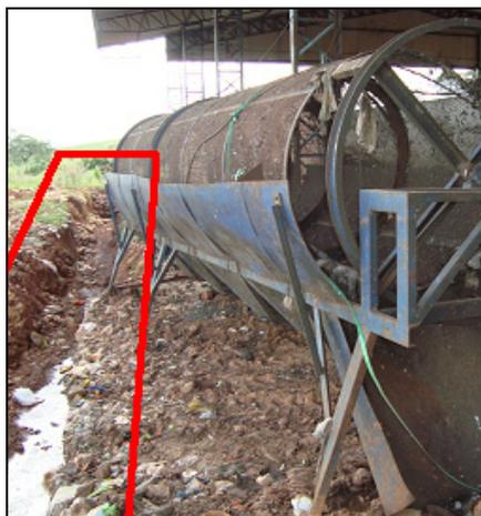
**Figura 10.2-LII: Calha coletora de chorume**
