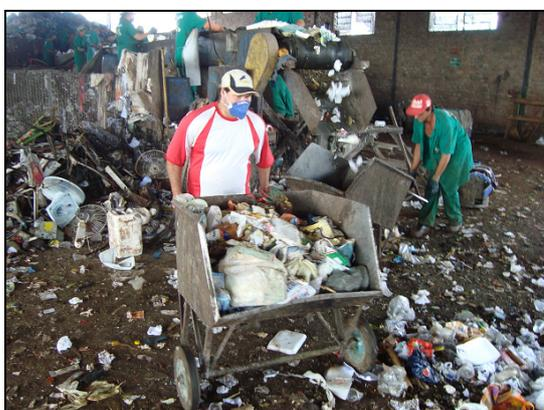
Figura 10.2-XLVI: Transporte do "rejeito da esteira de triagem" até a COMPOSTAGEM
