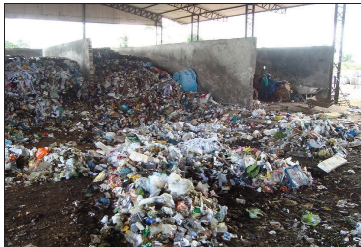
Figura 10.2-XLIX: Baias cobertas para o processo da compostagem
