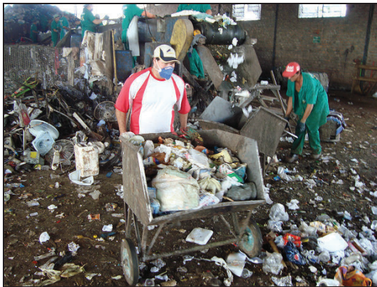
Figura 10.2-XLVI: Transporte do "rejeito da esteira de triagem" até a COMPOSTAGEM
